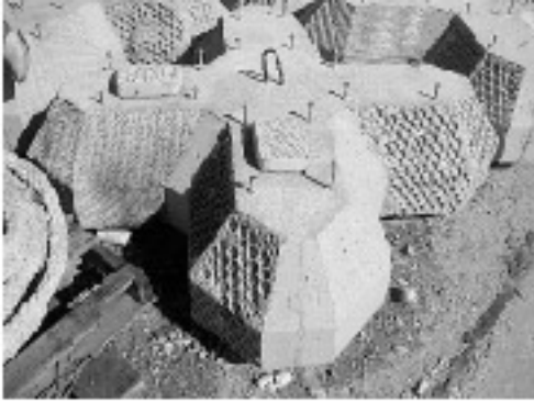
写真2. 附着基盤（コンクリートブロック）
